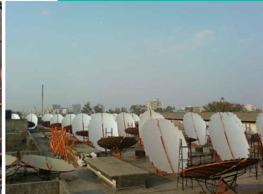
ឧបករណ៍ប្រមូលផ្តុំកម្ដៅពន្លឺព្រះអាទិត្យ Scheffler
