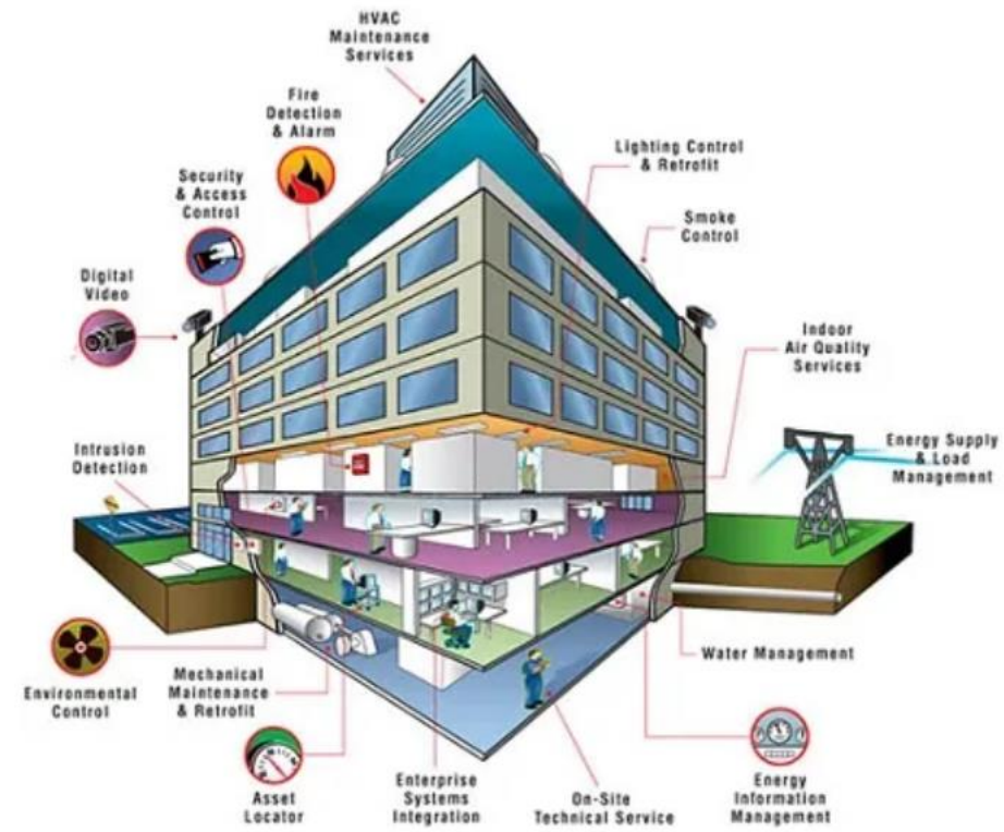
ការប្រើប្រាស់ប្រព័ន្ធ BAS នៅក្នុងអគារពាណិជ្ជកម្ម
