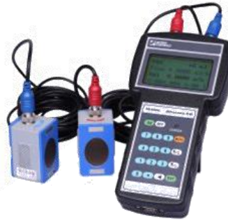
ឧបករណ៍វាស់លំហូរ ប្រភេទអាល់ត្រាសូនិក រូបភាព ៖ Acorn Controls
